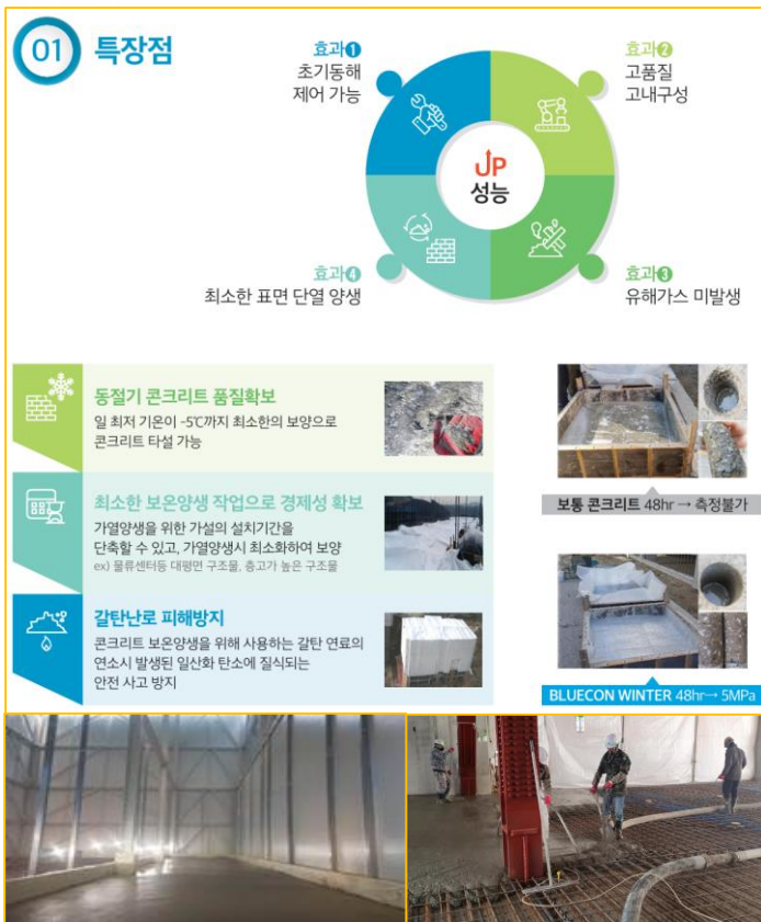
그림 8. 내한 콘크리트 특징점 및 적용 사례
