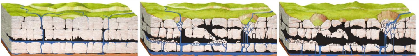
그림 1. 싱크홀 발생 원인(자연적 요인)
